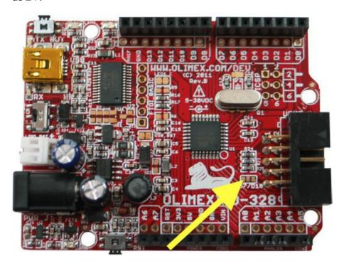
• Pont diviseur de mesure de la tension d'alimentation sur le point A7 ; l'échelle peut être adaptée aux valeurs des résistances du pont diviseur par la commande **VINMAX**
